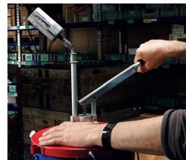
Simalube kan fyllas liksom återfyllas genom användning av en standard fettpump som vanligen används vid fyllning av fett-pistoler.
